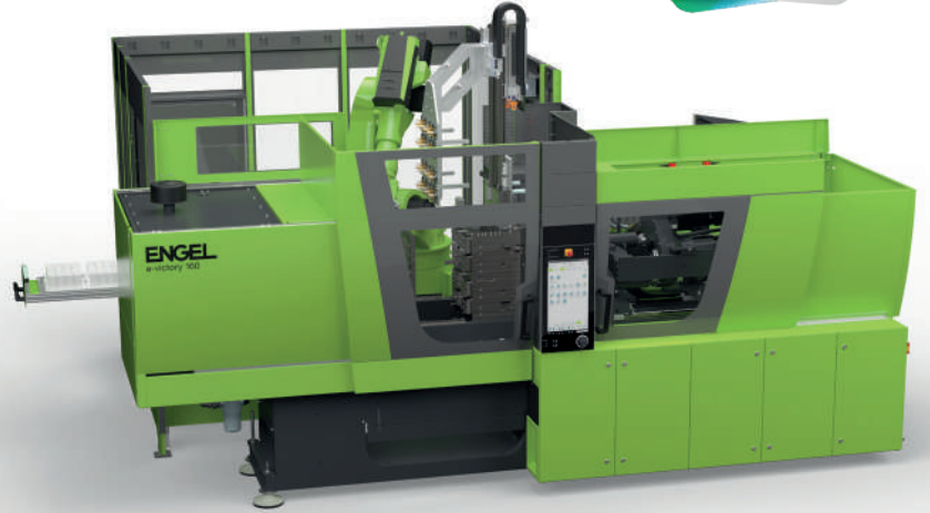
Yüksek kavite sayısı ve yüksek hassasiyet ve kompakt otomasyondan oluşan kombinasyon LSR koruyucu valflerin seri üretimini yeni bir verimlilik seviyesine çıkarmaktadır.
